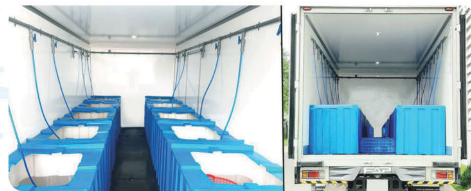
▲ Hình bố trí các bể chứa bằng composite và hệ thống cấp dưỡng khí (máy Oxy) bên trong thùng xe tải để chở thủy sản sống.
